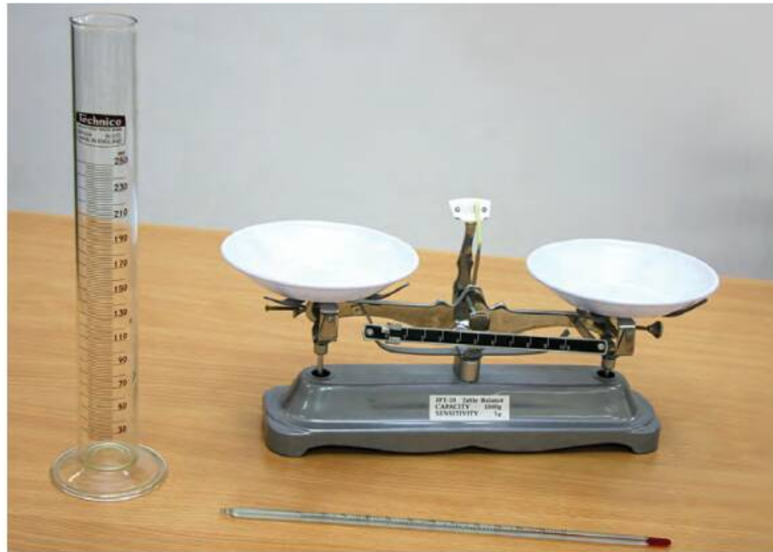
الشكل ١٢ بعض الأدوات التي يستخدمها العلماء. فيستخدم المخبر المدرج لقياس حجم السائل، ويستخدم الميزان لقياس الكتلة، بينما يستخدم مقياس الحرارة لقياس درجة الحرارة.
