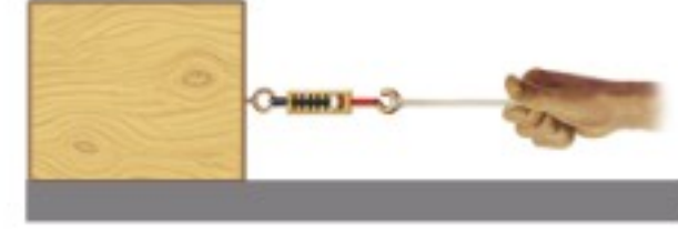
■ الشكل 9-5 يسحب الميزان النابضي الكتلة بقوة ثابتة.
