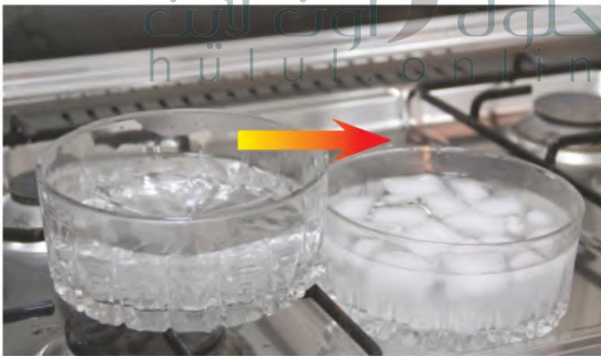
الشكل ٣ تنتقل الطاقة الحرارية بين جسمين إذا اختلفا في درجتي حرارتهما، وتنتقل من الجسم الأسخن إلى الجسم الأبرد دائمًا.
