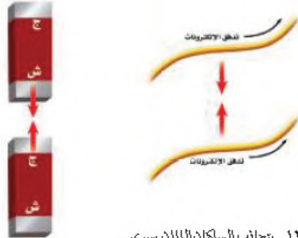
الشكل ١٢ يتجاذب السلكان اللذان يسري فيهما تياران كهربائيان في الاتجاه نفسه، كالأقطاب المغناطيسية المختلفة تماماً.
